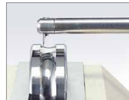
轴承的内圈/外圈轮廓
