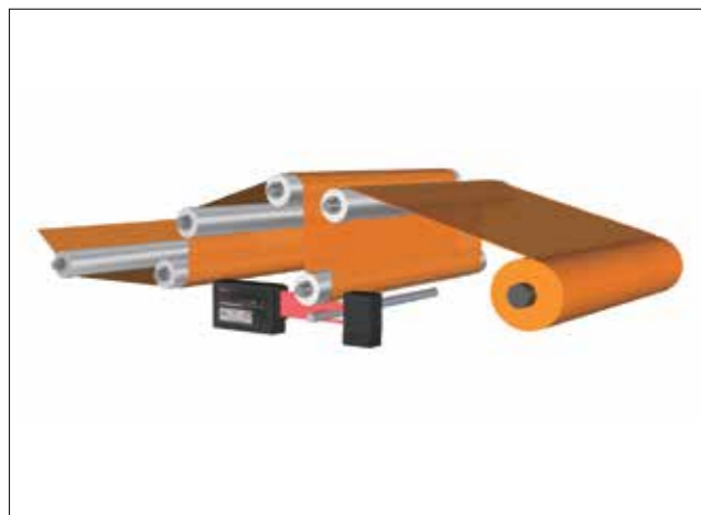
测量胶片、薄板的厚度
