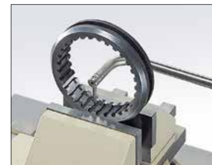
内齿轮齿形测量
