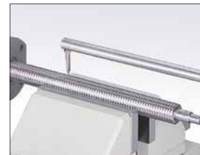
外螺纹形状测量
